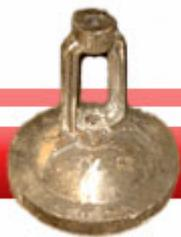
Литые заготовки для изготовления запорной арматуры (корпуса, крышки, обоймы, диски) Ду 50 - Ду 500 изготавливаются из коррозионно-стойких марок сталей 12Х18Н9ТЛ, 12Х18Н12МЗТЛ, 06ХН28МДТ.
