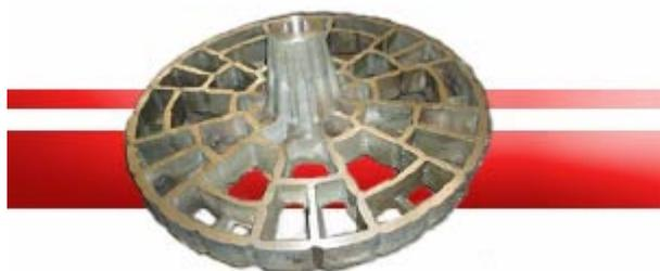
Оснастка для шахтных печей химико-термической обработки типа США, СШЦМ, Ц-105, Ц-75, Ц-60: реторты, тигли, муфели, обечайки корзин, днища корзин, диффузоры, травильные короба, стойки, крестовины, решетки, реторты эндогенераторов- из жаропрочных сталей и сплавов.
