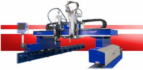
Предприятие производит раскрой стального листа толщиной от 0,5 до 150 мм на машинах плазменной и газовой резки.
