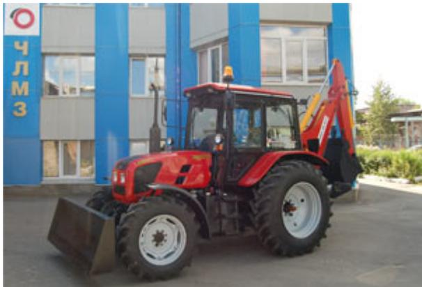
Экскаватор-бульдозер ЧЛМЗ ЭО 2621 предназначен для механизации земляных работ на грунтах I-IV категории. В качестве базового трактора используется трактор «Беларус-92П-Ч» с усиленным передним мостом повышенной грузоподъемности и реверс-редуктором. Широкий бульдозерный отвал (возможен жесткий, либо поворотный) связанный с рамой экскаваторного оборудования позволят эффективно выполнять планировочные и зачистные работы.
