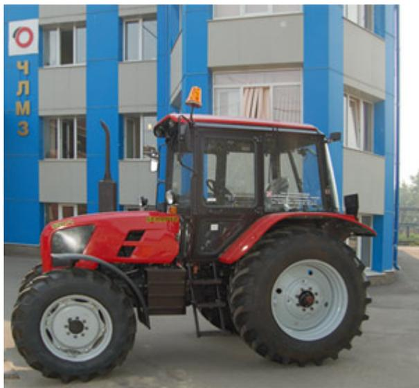
Базовое шасси трактора Беларус 92П-Ч предназначено для агрегатирования с монтируемым оборудованием различного назначения для выполнения работ в промышленности, строительстве и коммунальном хозяйстве: землеройных, экскаваторных, погрузочно-разгрузочных, по очистке дорог и пр. Наше предприятие выпускает модификацию трактора Беларус 92П-Ч с задней с/х навеской.
