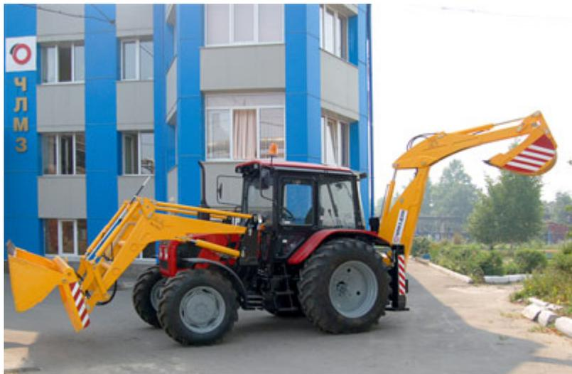
Экскаватор-погрузчик ЧЛМЗ ДЭМ-1143 предназначен для выполнения экскавационных и погрузочно-разгрузочных работ на грунтах I-III категории. В качестве базового трактора используются трактора МТЗ "Беларус 82.1", "Беларус-92П-Ч" и его модификации. Высокая универсальность использования и комфортные условия работы делают экскаватор-погрузчик ЧЛМЗ ДЭМ-1143 незаменимым в тяжелых условиях эксплуатации.
