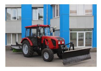
Машина коммунальная МК.02-921 сделана на базе трактора Беларус 921.3. Машина предназначена для выполнения уборочных и земляных работ, очистки улиц, площадей, дорог и тротуаров с твердым покрытием от мусора и свежевыпавшего снега, для планировки рыхлого насыпного грунта и засыпки им траншей и ям. Колесная формула 4х4 позволяет решать широкий круг задач в трудных дорожных условиях. При этом трактор сохраняет высокую экономичность и простоту эксплуатации.
