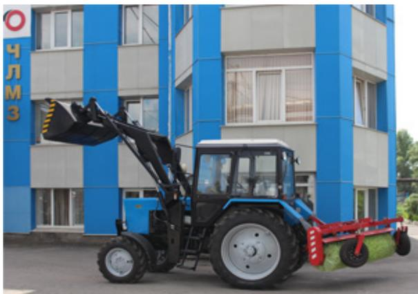
Трактор «Беларус 82.1МК» предназначен для выполнения уборочных и погрузочно-разгрузочных работ на грунтах I и II категории, работ по планировке, засыпке грунта, очистки улиц, площадей, дорог и тротуаров с твердым покрытием от мусора и свежеснегавывпавшего снега, для планировки рыхлого насыпного грунта и засыпки им траншей и ям. . Колесная формула 4x4 позволяет решать широкий круг задач в трудных дорожных условиях. При этом трактор сохраняет высокую экономичность и простоту эксплуатации.
