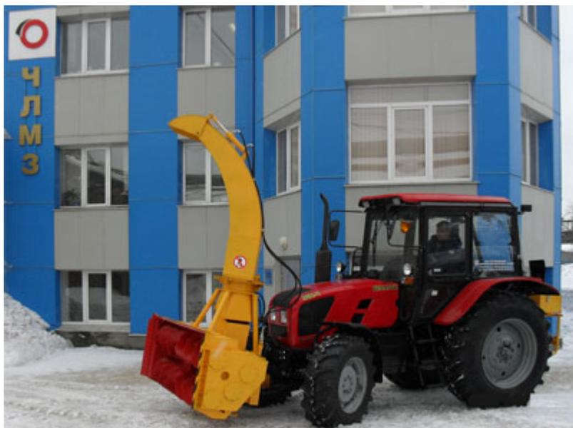
Снегоочиститель шнекороторный ЧЛМЗ ФРС – 200М предназначен для очистки дорожных покрытий от снега, а также для удаления снежных валов. Высокая надежность позволяет работать в сложных погодных условиях.
