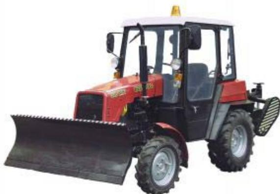
Трактор «Беларус 320-Ч.4МК» предназначен для выполнения коммунально-уборочных работ по очистке улиц, площадей и дорог от снега и мусора. Колесная формула 4x4 позволяет решать широкий круг задач в трудных дорожных условиях. При этом трактор сохраняет высокую экономичность и простоту эксплуатации.
