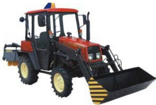
Трактор «Беларус 320-Ч.4МУП» предназначен для выполнения уборочных и погрузочно-разгрузочных работ на грунтах I и II категории, работ по планировке и засыпке грунта. Колесная формула 4x4 позволяет решать широкий круг задач в трудных дорожных условиях. При этом трактор сохраняет высокую экономичность и простоту эксплуатации.
