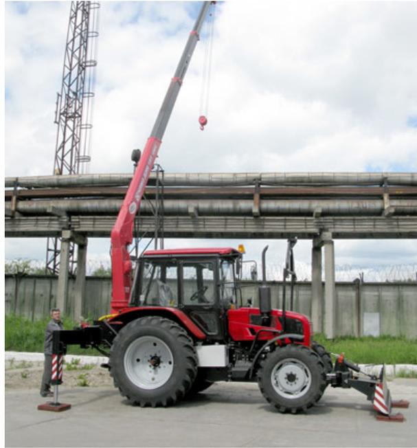
Телескопический кран-манипулятор ЧЛМЗ ДЭМ-151 UNIC на базе трактора «Беларус» 92П-4 предназначен для проведения погрузочно-разгрузочных работ, строительного-монтажных и других работ на высоте до 12 м, транспортировки грузов в агрегируемом прицепе, выполнения земляных и планировочных работ в небольших объемах. Высокая надежность и функциональность машины обусловлена применением крано-манипуляторной установки ведущего мирового производителя - японской фирмы «Furukawa Unic Corporation».
