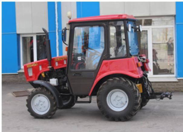
**Беларус 320-Ч** - колесный универсальный трактор, предназначен для работ в сельском хозяйстве, коммунальном хозяйстве, строительстве, на транспорте и в промышленности. Колесная формула 4x4 позволяет решать широкий круг задач в трудных дорожных условиях. При этом трактор сохраняет высокую экономичность и простоту эксплуатации. Наше предприятие выпускает две модификации Беларус 320-Ч: с двигателем Lombardini и с ММЗ.
