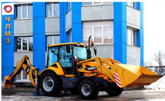
Экскаватор-погрузчик «ЧЛМЗ-310» предназначен для выполнения земляных работ в грунтах I-IV категорий. Допускается применение машины на мерзлых грунтах после предварительного разрыхления грунта.
